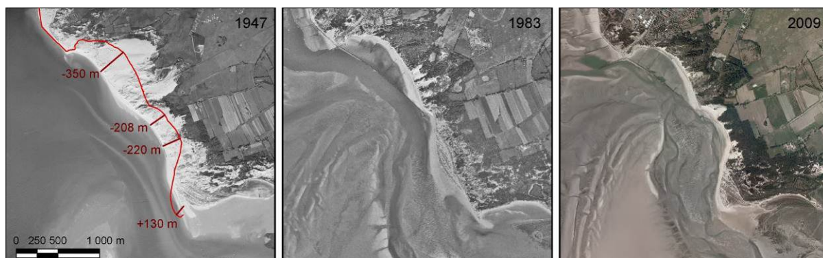
Figure 24 : Evolution du trait de côte entre 1947 et 2009 sur la rive nord de la baie d'Authie au niveau de, du sud vers le nord, le Bec du Perroquet, l'Anse du Bois des Sapins, la Grande Dune et l'Anse des Sternes (LOG-ULCO, 2013)
