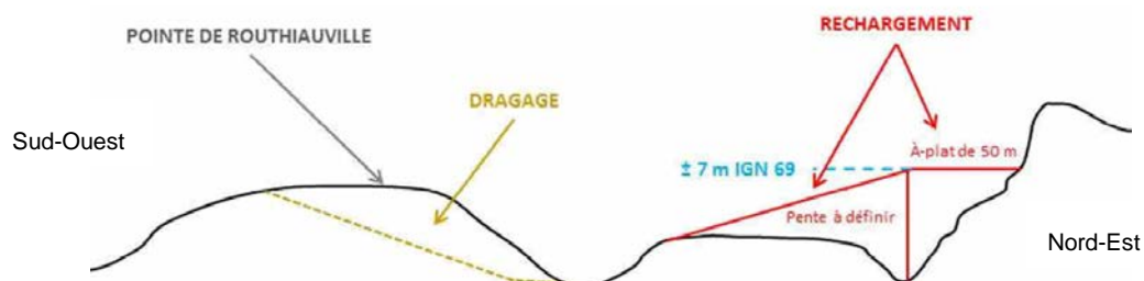
Figure 27 : Profil en travers schématique de la Baie d'Authie de l'Anse du Bois des Sapins jusqu'à la Pointe de Routhiauville (IDRA Environnement, 2013)
